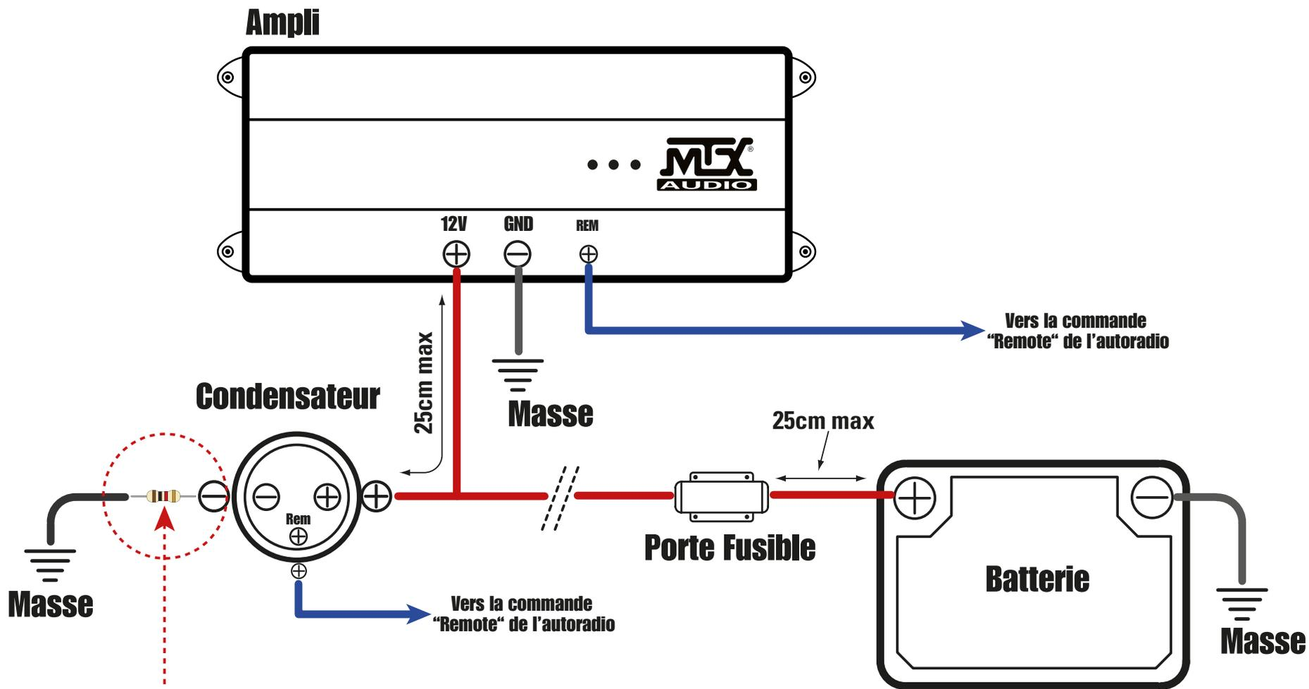
Résistance en série à brancher pendant 20 secondes au moment de la première connexion. Après 20 secondes la capa est chargée. Il faut enlever la résistance et brancher normalement la masse sur la capa.
